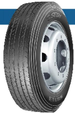
Diseño de banda de rodamiento de 5 ranuras con compuestos especiales que evita el desgaste irregular y mejora la tracción en toda posición para trayectos regionales
